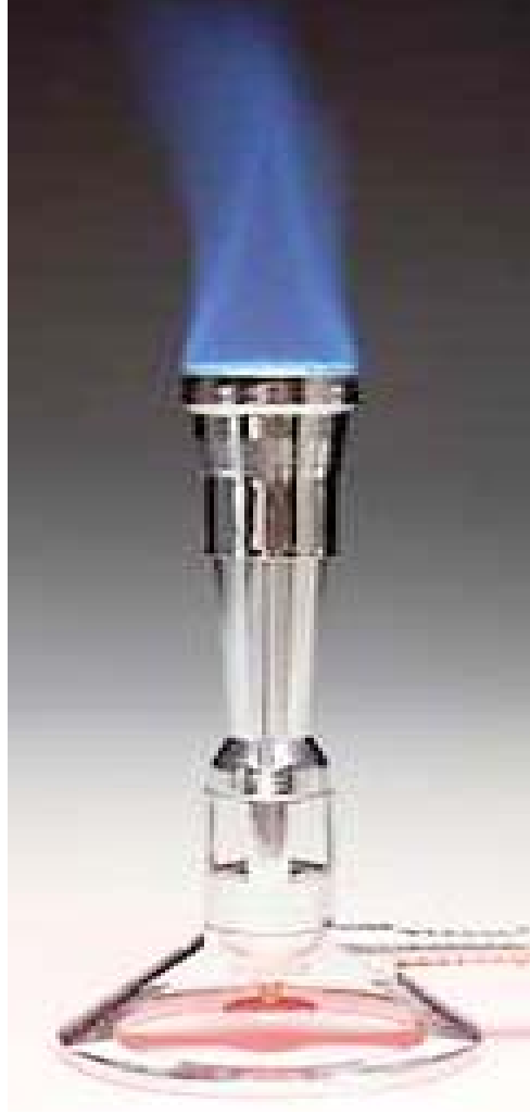
الشكل رقم (2-3) موقد بنزن وشعلة اللهب المستخدم في الكشف الجاف
